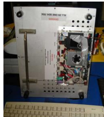
Afbeelding 3: De ingebouwde computer module op de bodem van de 19" behuizing
