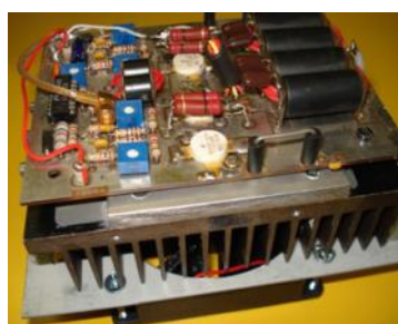
Type Component zijde van de 250 Watt 50 V Mosfet PA Module.
